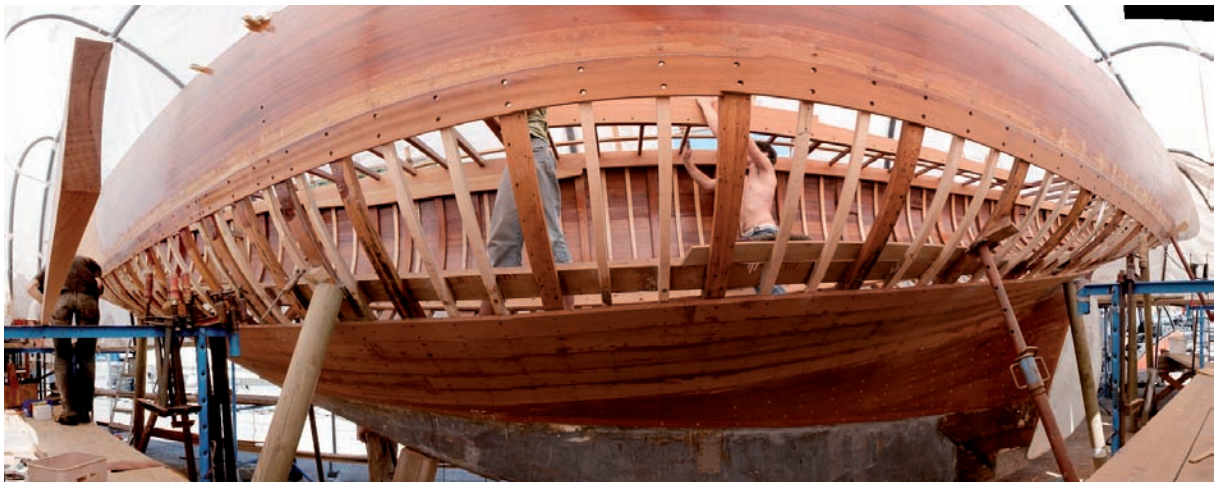
Fig. 16 : La coque du 8 m JI Vision en cours de restauration complète par le CN-Pasqui (Collection Pasqui Gilbert). The hull of the 8 m JI Vision, undergoing complete restoration in CN-Pasqui.
