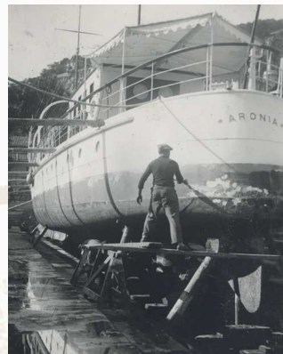
Carénage d'un gros yacht dans le bassin de radoub vers les années cinquante.
