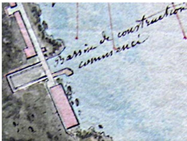
Figure 9 - Extrait d'un plan des lieux dressé sous la période d'occupation française et montrant la présence de la « forme » pour la construction des frégates ainsi que les deux môles contigus.
