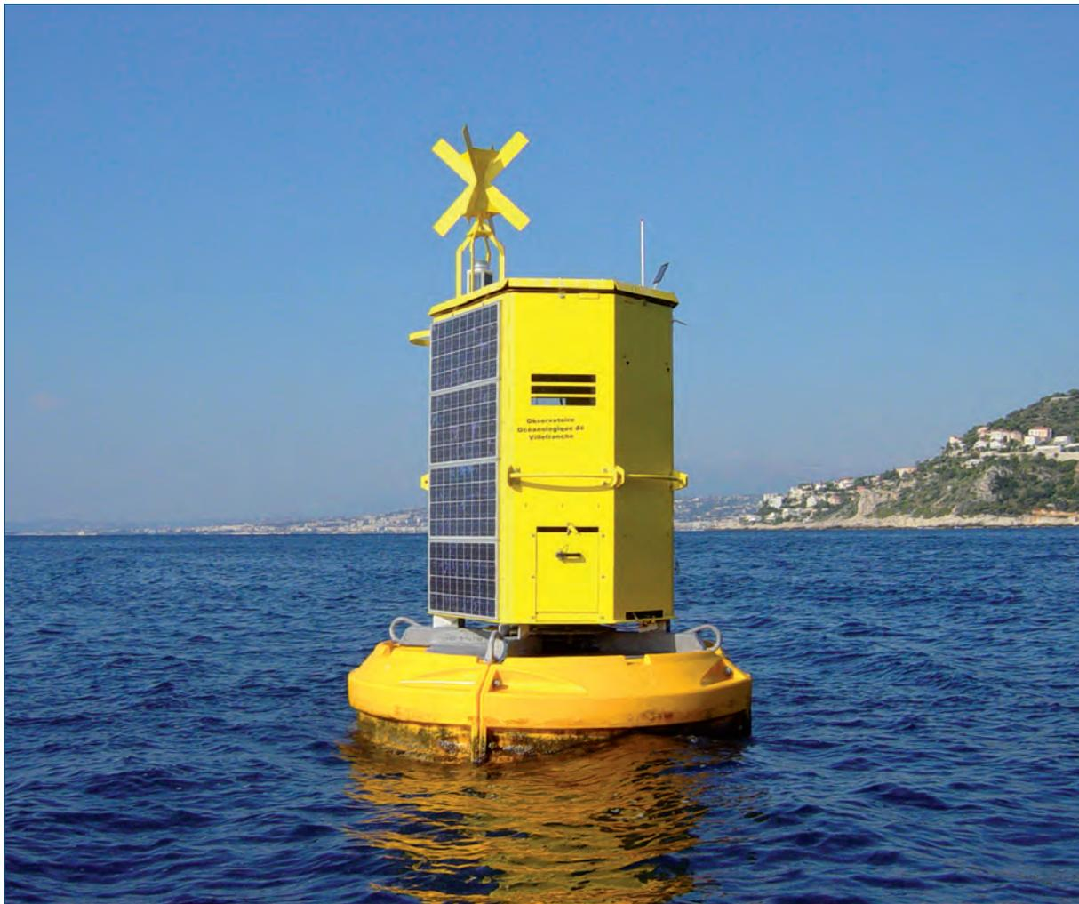
*Bouée E.O.L. (Environnement Observable Littoral) déployée en avril 2009 au large de Villefranche-sur-Mer pour réaliser de façon autonome des mesures de paramètres physico-chimique sur une colonne d'eau de 0 à 80 mètres.*
