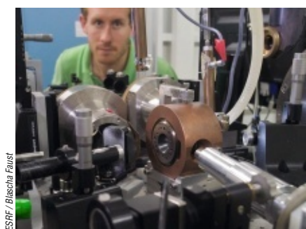
Un échantillon rocheux d'une cinquantaine de micromètres est comprimé entre deux pointes de diamant (dans le cylindre de cuivre rougeâtre au centre) et chauffé avec un laser.
